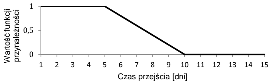
Rysunek 4.2 Funkcja przynależności dla czasu przejścia w procesie produkcji
